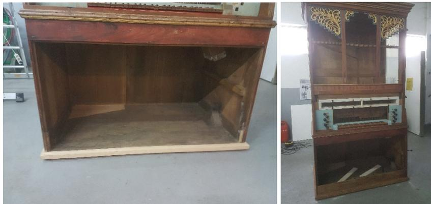
Figura 9 – Caixa do órgão esvaziada para desinfestação geral.
