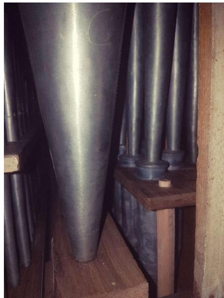
Figura 44 – Recolocação das palhetas no interior do instrumento, implantadas na primeira fila do someiro, logo atrás dos tubos componentes da intonação do instrumento.
