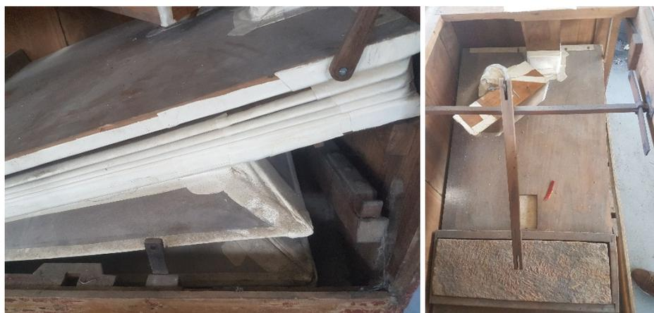
Figura 16 – Sistema de alimentação de vento antes da presente intervenção de conservação e restauro, na qual foi mantida a pedra original, garantindo a consequente manutenção da pressão do vento.
