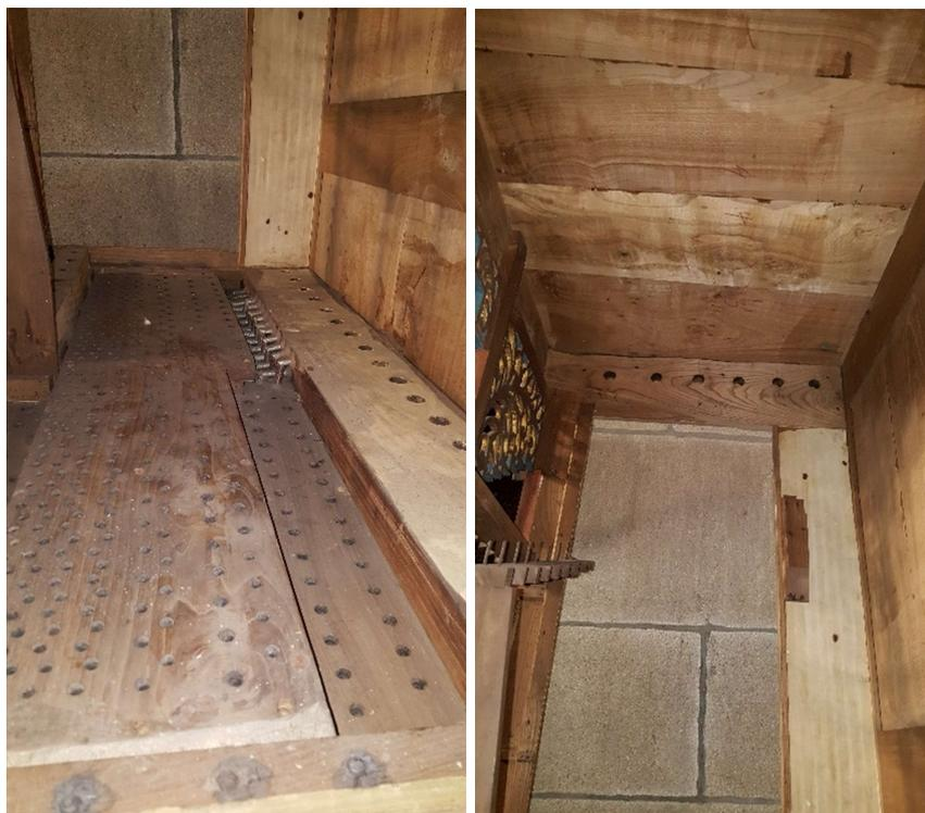
Figura 25 –Ao fundo (costado esquerdo) e parte superior da caixa do órgão, tabuões correspondentes à alimentação em vento dos seis tubos mais graves do registo *Violam* (mão esquerda), durante a desmontagem do instrumento.
