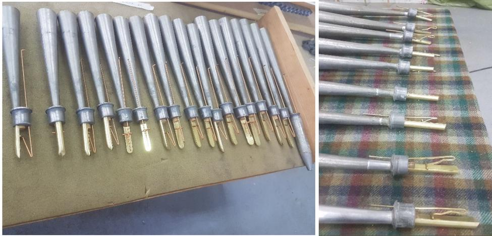
Figura 43 – Tubos de palheta já devidamente limpos e restaurados.
