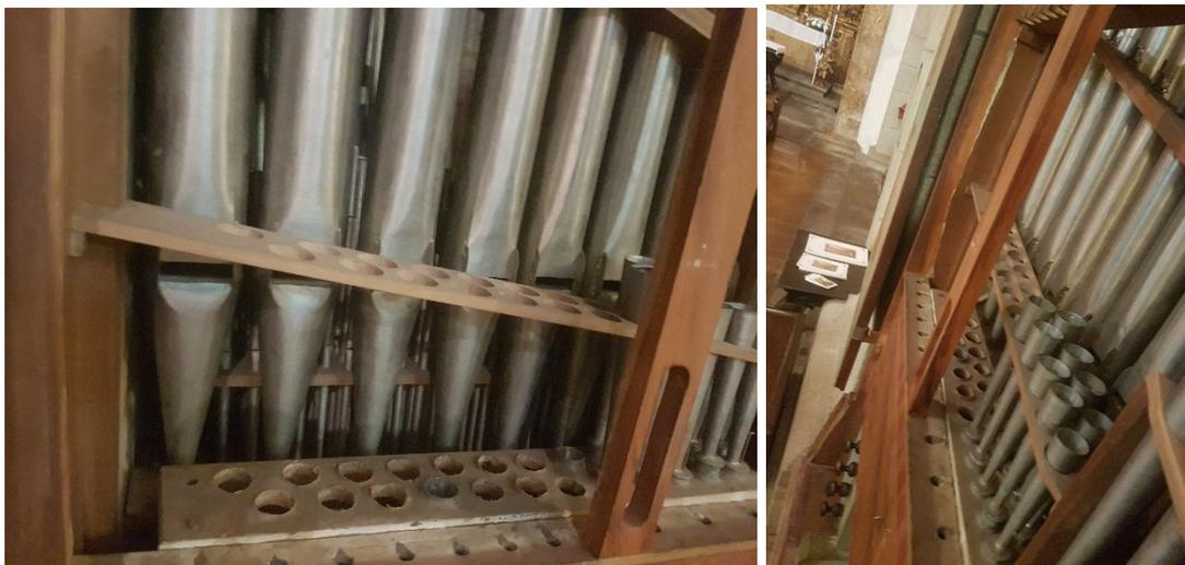
Figura 22 – Pandeiros e suportes superiores dos tubos de palheta na parte fronteira do someiro do órgão, logo atrás dos tubos de fachada (intonação do instrumento), durante a desmontagem do órgão.
