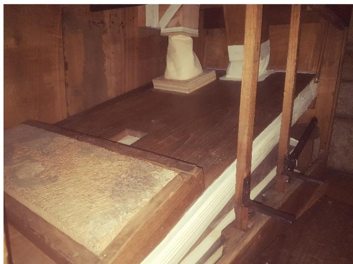
Figura 33 – O instrumento é também dotado de pedais anuladores de cheios, que ativam (pedal direito) ou anulam (pedal esquerdo) os registos *Quinzena, Desanovena, Cheio* da mão esquerda, bem como os registos *8.ª Real, Dozena, Cheio* da mão direita, uma vez pré-selecionados na consola do instrumento.
