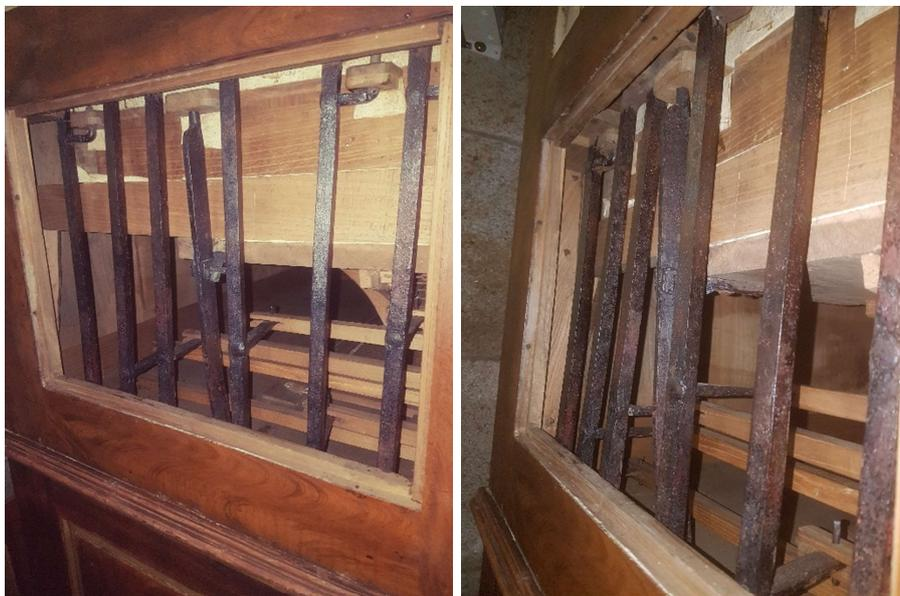
Figura 27 – Pormenores da mecânica de registos original do instrumento após o seu restauro.
