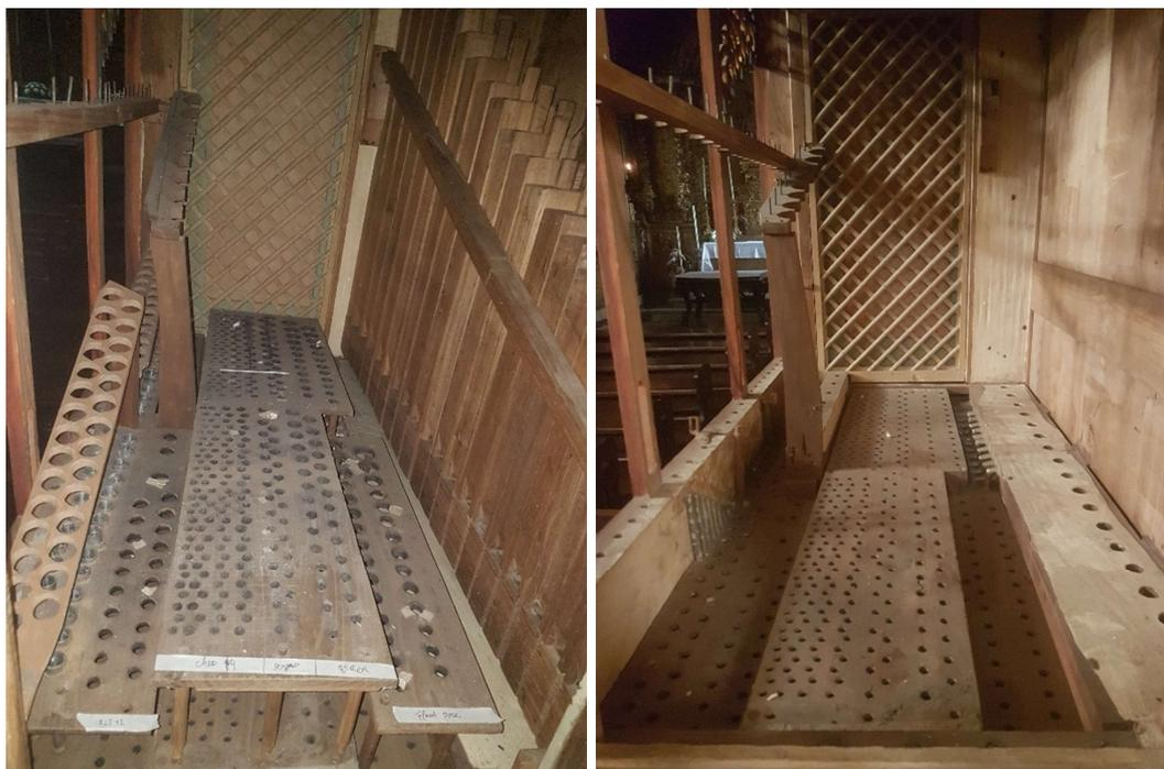
Figura 23 – Parte superior do someiro do órgão: a esq., pandeiros e suportes superiores dos tubos; à dir., tampas do someiro, durante a desmontagem do instrumento.
