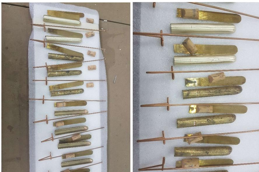
Figura 42 – Armazenamento das cânulas, linguetas, cunhas e afinadores dos tubos de palheta.
